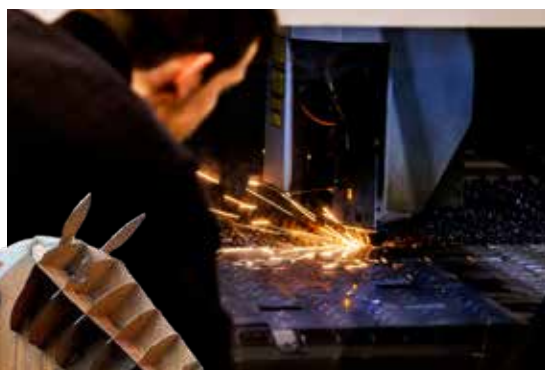
Schritt 1: Konturen lasern
