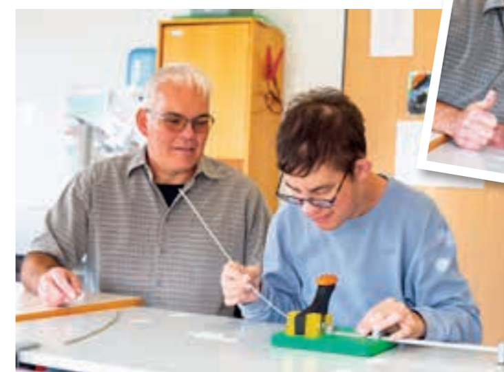
Ablängvorrichtung für Auffädelstangen der Firma Saint-Gobain
